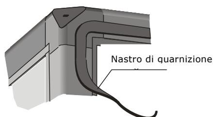
In caso di impianti igienici, al montaggio in loco, le scanalature dei punti di separazione all'interno della parte inferiore dell'impianto devono essere sigillati con materiale resistente ai disinfettanti.
